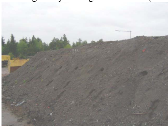
Figur 3: Sedimentprovtagning där högen delades in i ett rutnät och 3x12 prover togs till ett samlingsprov.
